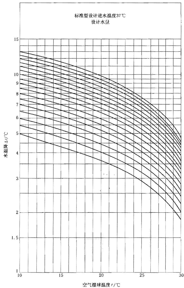
图 C.4 冷却塔  $\Delta t-\tau$  曲线图
