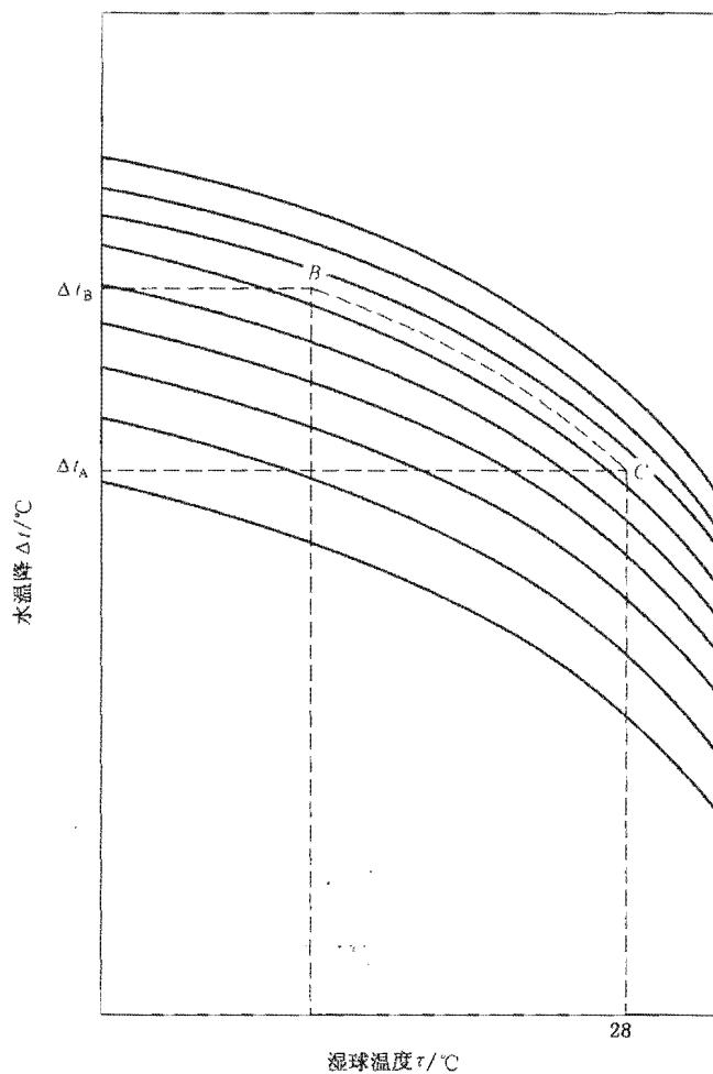
图 C.5 求解标准工况水温降
