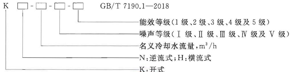
示例: 名义冷却水流量  $125 \text{ m}^3/\text{h}$ 、噪声等级为 II 级, 能效等级为 I 级的机械通风逆流开式冷却塔标记为:
